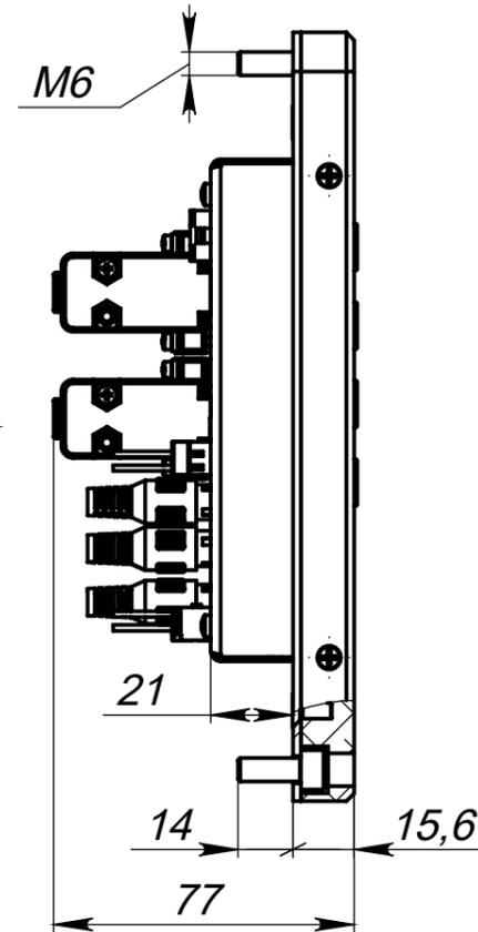
Установочные размеры для монтажа панели (1:4)
