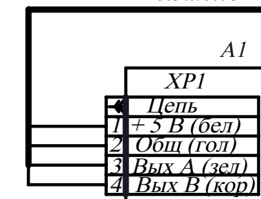
Схема подключений ПАВМ-0.5...0.75
